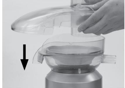
5. Heben Sie den Sicherheitsverriegelungsbügel an und klemmen Sie ihn in die zwei Rillen auf beiden Seiten der Entsafterabdeckung.
